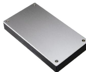
CFDFR1000-24系列DC/DC模块采用先进的电路技术和工艺结构,实现超高电源转换效率;该模块产品采取定频控制,输入输出隔离,支持板上焊接使用;该系列产品采用全密闭封装,确保其在严酷条件下的正常工作;该系列产品适用于工业,车载,军工等领域。
