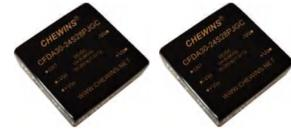
CFDA30型全国产化DC-DC转换器，1英寸\*1英寸超小体积，采用铜壳感应焊工艺，适合可靠性要求高的场合，超轻量化，元器件100%国产化，效率高达90%，隔离电压:1500VDC，国际标准引脚方式；产品设计与制造满足SJ20668-1998《微电路模块总规范》和产品详细规范的要求。特别适合航空航天船舶、兵器等领域对功率、效率、体积、重量、高度等要求极端严苛的高可靠电子系统。
