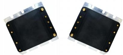
CFJM-FIAM型DC-DC转换器是工业标准1/2砖，输入电压180-375V，对标 vicor 公司 M-FIAM3M21 输入滤波衰减模块，半砖尺寸，输入180V-375V，输出电流3A，主要功能是与我公司CFMV300系列DCDC模块使用，可为 DCIDC 模块提供 EMI 滤波、瞬态保护以及浪涌电流抑制作用，满足电磁兼容要求高的使用场合。:产品设计及制造满足SJ20668-1998《微电路模块总规范》和产品详细规范的要求。特别适合航空航天船舶、兵器等领域对功率、效率、体积、重量、高度等要求极端严苛的高可靠电子系统。
