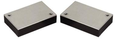
CFMQBS型DC-DC转换器是工业标准1/4砖，本型号电源模块是9V-36V/18V-36V范围输入，最大功率可达到200W，最大效率高达90%的1/8砖系列隔离模块，具有输入欠压、输出过压、输出过流、输出短路及过温保护等保护功能。电源采用先进的控制拓扑电路、先进的功率处理、控制及封装技术，具有高效率、高功率密度、低噪声等优点；产品设计及制造满足SJ20668-1998《微电路模块总规范》和产品详细规范的要求。特别适合航空航天船舶、兵器等领域对功率、效率、体积、重量、高度等要求极端严苛的高可靠电子系统。
