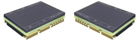
CFJBCM48BF型DC-DC转换器是基于革命性ChiP（Converter housed in Package，转换器级封装）技术的最新一代微晶片电源。采用先进的功率拓扑，控制及封装技术，具有高效率，超高功率密度，超小体积，超轻量化等可在38V至55VDC的宽输入范围内可靠工作；将控制器、功率管、平面磁性元件以及辅助器件集成在高密度表贴封装内，降低对输入和输出滤波要求，进一步减小总体方案的尺寸和成本；具有输入过欠压保护，输出过压、过流，短路保护以及过温保护、温度监控等功能。产品设计与制造满足SJ20668-1998《微电路模块总规范》和产品详细规范的要求。特别适合航空、航天、船舶、兵器等领域对功率、效率、体积、重量、高度等要求极端严苛的高可靠电子系统。
