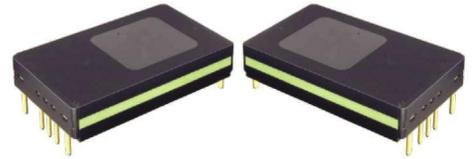
CFJDCM28BC型DC-DC转换器是基于革命性ChiP（Converter housed in Package，转换器级封装）技术的最新一代微晶片电源。采用先进的功率拓扑、控制及封装技术，具有高效率，超高功率密度，超小体积，超轻重量等可在16V至50VDC的宽输入范围内可靠工作；将控制器、功率管、平面磁性元件以及辅助器件集成在高密度表贴封装内，降低对输入和输出滤波要求，进一步减小总体方案的尺寸和成本；具有输入过欠压保护，输出过压、过流，短路保护以及过温保护、温度监控等功能。产品设计与制造满足SJ20668-1998《微电路模块总规范》和产品详细规范的要求。特别适合航空、航天、船舶、兵器等领域对功率、效率、体积、重量、高度等要求极端严苛的高可靠电子系统。
