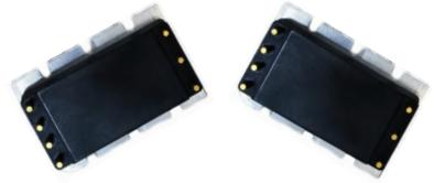
CFMVI-ARM型DC-DC转换器是工业标准1/4砖，本产品是一款交流前端滤波整流模块，可提供交流输入整流，浪涌电流限制等功能。产品可与我司生产的CFMV300V输入DCDC转换器配合使用，组成一个具有高功率密度、低高度的开关电源。ARM包括一个微控制器，可持续监控交流线路以控制桥式电路工作状态。用户只需提供外部电容，以满足系统保持时间的要求。：产品设计与制造满足SJ20668-1998《微电路模块总规范》和产品详细规范的要求。特别适合航空航天船舶、兵器等领域对功率、效率、体积、重量、高度等要求极端严苛的高可靠电子系统。
