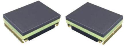
CFJPI28H05型DC-DC转换器是基于革命性ChiP（Converter housed in Package，转换器级封装）技术的最新一代微晶片电源。采用高性能ZVS拓扑结构，可在16V至50VDC的宽输入范围内可靠工作；将控制器、功率管、平面磁性元件以及辅助器件集成在高密度表贴封装内，具有高达334W/in<sup>3</sup>的超高功率密度，重量仅为7.8g采用高开关频率，降低对输入和输出滤波要求，进一步减小总体方案的尺寸和成本；具有输入过欠压保护，输出过压、过流，短路保护以及过温保护、温度监控等功能。产品设计与制造满足SJ20668-1998《微电路模块总规范》和产品详细规范的要求。特别适合航空、航天、船舶、兵器等领域对功率、效率、体积、重量、高度等要求极端严苛的高可靠电子系统。
