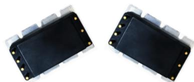
CFMV375C型DC-DC转换器是工业标准1/4砖，输入电压250-425V，最大输出功率150W，内部贴片式设计，国际标准引脚方式，电源采用先进的控制拓扑电路，先进的功率处理控制及封装技术，具有高效率，高功率密度，低噪声等优点；具有输入过欠压保护，输出过流保护，过温保护等功能；产品设计与制造满足SJ20668-1998《微电路模块总规范》和产品详细规范的要求。特别适合航空、航天、船舶、兵器等领域对功率、效率、体积、重量、高度等要求极端严苛的高可靠电子系统。
