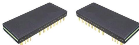
CFJBCM384EC型DC-DC转换器是基于革命性ChiP（Converter housed in Package，转换器级封装）技术的最新一代微晶片电源。采用先进的功率拓扑，控制及封装技术，具有高效率，超高功率密度，超小体积，超重量等，可在360V至400VDC的宽输入范围内可靠工作；将控制器、功率管、平面磁性元件以及辅助器件集成在高密度表贴封装内，降低对输入和输出滤波要求，进一步减小总体方案的尺寸和成本；具有输入过欠压保护，输出过压、过流，短路保护以及过温保护、温度监控等功能。产品设计与制造满足SJ20668-1998《微电路模块总规范》和产品详细规范的要求。特别适合航空、航天、船舶、兵器等领域对功率、效率、体积、重量、高度等要求极端严苛的高可靠电子系统。
