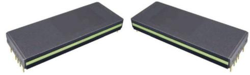
CFJBCM384WDC型DC-DC转换器是基于革命性ChiP（Converter housed in Package，转换器级封装）技术的最新一代微晶片电源。采用先进的功率拓扑，控制及封装技术，具有高效率，超高功率密度，超小体积，超轻量化等，可在260V至410VDC的宽输入范围内可靠工作；将控制器、功率管、平面磁性元件以及辅助器件集成在高密度表贴封装内，降低对输入和输出滤波要求，进一步减小总体方案的尺寸和成本；具有输入过欠压保护，输出过压、过流，短路保护以及过温保护、温度监控等功能。产品设计与制造满足SJ20668-1998《微电路模块总规范》和产品详细规范的要求。特别适合航空、航天、船舶、兵器等领域对功率、效率、体积、重量、高度等要求极端严苛的高可靠电子系统。
