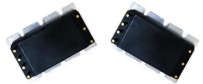
CFM $\mu$ RAM型DC-DC转换器是工业标准1/4砖，输入电压3-30V，产品内置一个无源滤波器，有效地衰减在 50kHz 至 1MHz 间的纹波。另有一个有源滤波器亦可把到最高 1MHz 的范围内的纹波进行衰减。纹波衰减模块内部使用有源和无源滤波器抑制纹波，可以在 VREF 脚增加滤波电容，有效抑制低频纹波。：产品设计与制造满足SJ20668-1998《微电路模块总规范》和产品详细规范的要求。特别适合航空航天船舶、兵器等领域对功率、效率、体积、重量、高度等要求极端严苛的高可靠电子系统。
