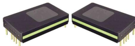
CFJDCM270AC型DC-DC转换器是基于革命性ChiP（Converter housed in Package，转换器级封装）技术的最新一代微晶片电源。采用先进的功率拓扑、控制及封装技术，具有高效率、超高功率密度、超小体积、超轻重量等，可在160V至420VDC的宽输入范围内可靠工作；将控制器、功率管、平面磁性元件以及辅助器件集成在高密度表贴封装内，降低对输入和输出滤波要求，进一步减小总体方案的尺寸和成本；具有输入过欠压保护，输出过压、过流，短路保护以及过温保护、温度监控等功能。产品设计与制造满足SJ20668-1998《微电路模块总规范》和产品详细规范的要求。特别适合航空、航天、船舶、兵器等领域对功率、效率、体积、重量、高度等要求极端严苛的高可靠电子系统。
