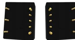
CFMMBS型DC-DC转换器是工业标准1/32砖，本型号电源模块是9V-36V/36V-75V范围输入，最大功率可达到40W，最大效率高达86%的1/32砖系列隔离模块，具有输入欠压、输出过压、输出过流、输出短路及过温保护等保护功能。电源采用先进的控制拓扑电路、先进的功率处理、控制及封装技术，具有高效率、高功率密度、低噪声等优点；产品设计及制造满足SJ20668-1998《微电路模块总规范》和产品详细规范的要求。特别适合航空航天船舶、兵器等领域对功率、效率、体积、重量、高度等要求极端严苛的高可靠电子系统。
