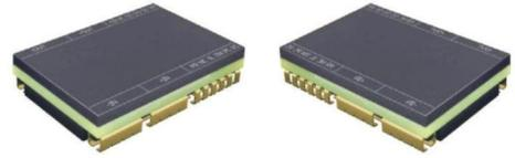
CFJPRM36F型DC-DC转换器是基于革命性ChiP（Converter housed in Package，转换器级封装）技术的新一代微晶片电源。采用先进的功率拓扑、控制及封装技术，具有高效率，超高功率密度，超小体积，超轻重量等可在18V至60VDC的宽输入范围内可靠工作；将控制器、功率管、平面磁性元件以及辅助器件集成在高密度表贴封装内，降低对输入和输出滤波要求，进一步减小总体方案的尺寸和成本；具有输入过欠压保护，输出过压、过流短路保护以及过温保护、温度监控等功能。产品设计与制造满足SJ20668-1998《微电路模块总规范》和产品详细规范的要求。特别适合航空、航天、船舶、兵器等领域对功率、效率、体积、重量、高度等要求极端严苛的高可靠电子系统。
