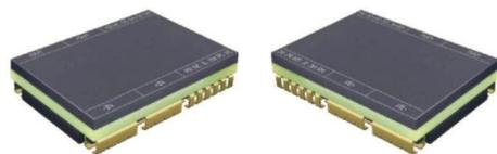
CFJVTM36F型DC-DC转换器是基于革命性ChiP（Converter housed in Package，转换器级封装）技术的最新一代微晶片电源。采用先进的功率拓扑，控制及封装技术，具有高效率，超高功率密度，超小体积，超轻量化等可在26V至50VDC的宽输入范围内可靠工作；将控制器、功率管、平面磁性元件以及辅助器件集成在高密度表贴封装内，降低对输入和输出滤波要求，进一步减小总体方案的尺寸和成本；具有输入过欠压保护，输出过压、过流，短路保护以及过温保护、温度监控等功能。产品设计与制造满足SJ20668-1998《微电路模块总规范》和产品详细规范的要求。特别适合航空、航天、船舶、兵器等领域对功率、效率、体积、重量、高度等要求极端严苛的高可靠电子系统。
