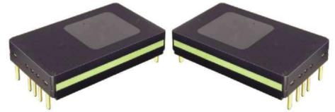
CFJDCM48BC型DC-DC转换器是基于革命性ChiP（Converter housed in Package，转换器级封装）技术的最新一代微晶片电源。采用先进的功率拓扑、控制及封装技术，具有高效率，超高功率密度，超小体积，超轻重量等，可在36V至75VDC的宽输入范围内可靠工作；将控制器、功率管、平面磁性元件以及辅助器件集成在高密度表贴封装内，降低对输入和输出滤波要求，进一步减小总体方案的尺寸和成本；具有输入过欠压保护，输出过压、过流，短路保护以及过温保护、温度监控等功能。产品设计与制造满足SJ20668-1998《微电路模块总规范》和产品详细规范的要求。特别适合航空、航天、船舶、兵器等领域对功率、效率、体积、重量、高度等要求极端严苛的高可靠电子系统。
