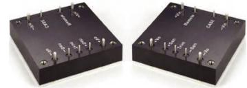
CFMHBS型DC-DC转换器是工业标准1/2砖，本型号电源模块是36V-75V/18V-36V范围输入，最大功率可达到600W，最大效率高达 91%的 1/2砖系列隔离模块，具有输入欠压、输出过压、输出过流、输出短路及过温保护等保护功能。电源采用先进的控制拓扑电路、先进的功率处理、控制及封装技术，具有高效率、高功率密度、低噪声等优点；产品设计与制造满足SJ20668-1998《微电路模块总规范》和产品详细规范的要求。特别适合航空航天船舶、兵器等领域对功率、效率、体积、重量、高度等要求极端严苛的高可靠电子系统。
