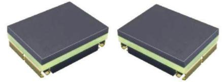
CFJPI24H型DC-DC转换器是基于革命性ChiP（Converter housed in Package，转换器级封装）技术的最新一代微晶片电源。采用高性能ZVS拓扑结构，可在18V至36VDC的宽输入范围内可靠工作；将控制器、功率管、平面磁性元件以及辅助器件集成在高密度表贴封装内，具有高达334W/in<sup>3</sup>的超高功率密度，重量仅为7.8g采用高开关频率，降低对输入和输出滤波要求，进一步减小总体方案的尺寸和成本；具有输入过欠压保护，输出过压、过流，短路保护以及过温保护、温度监控等功能。产品设计与制造满足SJ20668-1998《微电路模块总规范》和产品详细规范的要求。特别适合航空、航天、船舶、兵器等领域对功率、效率、体积、重量、高度等要求极端严苛的高可靠电子系统。
