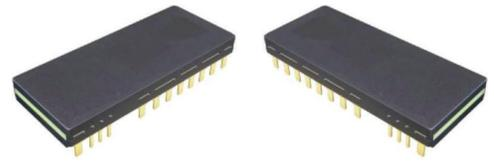
CFJBCM384WEC型DC-DC转换器是基于革命性ChiP（Converter housed in Package，转换器级封装）技术的最新一代微晶片电源。采用先进的功率拓扑、控制及封装技术，具有高效率、超高功率密度、超小体积、超小重量等可在260V至410VDC的宽输入范围内可靠工作；将控制器、功率管、平面磁性元件以及辅助器件集成在高密度表贴封装内，降低对输入和输出滤波要求，进一步减小总体方案的尺寸和成本；具有输入过欠压保护，输出过压、过流，短路保护以及过温保护、温度监控等功能。产品设计与制造满足SJ20668-1998《微电路模块总规范》和产品详细规范的要求。特别适合航空、航天、船舶、兵器等领域对功率、效率、体积、重量、高度等要求极端严苛的高可靠电子系统。
