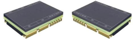
CFJPRM28F型DC-DC转换器是基于革命性ChiP（Converter housed in Package，转换器级封装）技术的最新一代微晶片电源。采用先进的功率拓扑,控制及封装技术,具有高效率,超高功率密度,超小体积,超轻量化等可在16V至50VDC的宽输入范围内可靠工作;将控制器、功率管、平面磁性元件以及辅助器件集成在高密度表贴封装内,降低对输入和输出滤波要求,进一步减小总体方案的尺寸和成本;具有输入过欠压保护,输出过压、过流短路保护以及过温保护、温度监控等功能。产品设计与制造满足SJ20668-1998《微电路模块总规范》和产品详细规范的要求。特别适合航空、航天、船舶、兵器等领域对功率、效率、体积、重量、高度等要求极端严苛的高可靠电子系统。
