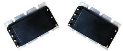
CFMV300C型DC-DC转换器是工业标准1/4砖，输入电压180-375V，最大输出功率150W，内部贴片化设计，国际标准引脚方式，电源采用先进的控制拓扑电路，先进的功率处理控制及封装技术，具有高效率，高功率密度，低噪声等优点；具有输入过欠压保护，输出过流保护，过温保护等功能；产品设计与制造满足SJ20668-1998《微电路模块总规范》和产品详细规范的要求。特别适合航空、航天、船舶、兵器等领域对功率、效率、体积、重量、高度等要求极端严苛的高可靠电子系统。
