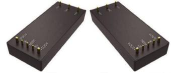
CFMEBS型DC-DC转换器是工业标准1/8砖，本型号电源模块是9V-36V/18V-36V范围输入，最大功率可达到150W，最大效率高达90%的1/8砖系列隔离模块，具有输入欠压、输出过压、输出过流、输出短路及过温保护等保护功能。电源采用先进的控制拓扑电路、先进的功率处理、控制及封装技术，具有高效率、高功率密度、低噪声等优点；产品设计及制造满足SJ20668-1998《微电路模块总规范》和产品详细规范的要求。特别适合航空航天船舶、兵器等领域对功率、效率、体积、重量、高度等要求极端严苛的高可靠电子系统。
