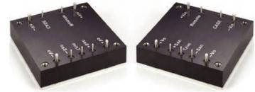
CFMHPF型DC-DC转换器是工业标准全砖，单相功率因数校正模块采用4路交错并联的boost拓扑电路，先进的功率处理、控制及封装技术，具有高效率、高功率密度、高功率因数、低谐波失真，并联均流度高等优点；采用标准工业半砖，典型效率高达96.5%；具有输入过、欠压保护，输出过压保护、输出短路保护、过温保护等功能。产品设计与制造满足SJ20668-1998《微电路模块总规范》和产品详细规范的要求。特别适合航空航天船舶、兵器等领域对功率、效率、体积、重量、高度等要求极端严苛的高可靠电子系统。
