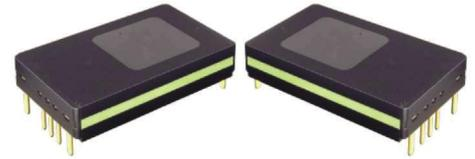
CFJDCM275AC型DC-DC转换器是基于革命性ChiP（Converter housed in Package，转换器级封装）技术的最新一代微晶片电源。采用先进的功率拓扑、控制及封装技术，具有高效率，超高功率密度，超小体积，超轻重量等，可在120V至420VDC的宽输入范围内可靠工作；将控制器、功率管、平面磁性元件以及辅助器件集成在高密度表贴封装内，降低对输入和输出滤波要求，进一步减小总体方案的尺寸和成本；具有输入过欠压保护，输出过压、过流，短路保护以及过温保护、温度监控等功能。产品设计与制造满足SJ20668-1998《微电路模块总规范》和产品详细规范的要求。特别适合航空、航天、船舶、兵器等领域对功率、效率、体积、重量、高度等要求极端严苛的高可靠电子系统。
