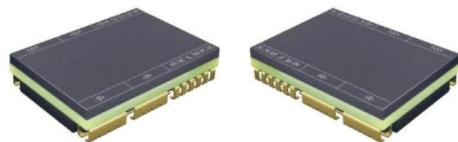
CFJPRM48CF型DC-DC转换器是基于革命性ChiP（Converter housed in Package，转换器级封装）技术的最新一代微晶片电源。采用先进的功率拓扑、控制及封装技术，具有高效率、超高功率密度、超小体积、超轻量化等可在45V至55VDC的宽输入范围内可靠工作；将控制器、功率管、平面磁性元件以及辅助器件集成在高密度表贴封装内，降低对输入和输出滤波要求，进一步减小总体方案的尺寸和成本；具有输入过欠压保护，输出过压、过流，短路保护以及过温保护、温度监控等功能。产品设计与制造满足SJ20668-1998《微电路模块总规范》和产品详细规范的要求。特别适合航空、航天、船舶、兵器等领域对功率、效率、体积、重量、高度等要求极端严苛的高可靠电子系统。
