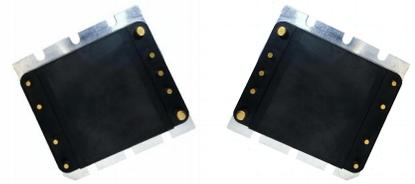
CFMV375B型DC-DC转换器是工业标准1/2砖，输入电压250-425V，最大输出功率300W，内部贴片化设计，国际标准引脚方式，电源采用先进的控制拓扑电路，先进的功率处理控制及封装技术，具有高效率，高功率密度，低噪声等优点；具有输入过欠压保护，输出过流保护，过温保护等功能；产品设计与制造满足SJ20668-1998《微电路模块总规范》和产品详细规范的要求。特别适合航空、航天、船舶、兵器等领域对功率、效率、体积、重量、高度等要求极端严苛的高可靠电子系统。
