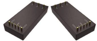
CFMEBS型DC-DC转换器是工业标准1/8砖，本型号电源模块是36V-75V/180V-400V范围输入，最大功率可达到140W，最大效率高达90%的1/8砖系列隔离模块，具有输入欠压、输出过压、输出过流、输出短路及过温保护等保护功能。电源采用先进的控制拓扑电路、先进的功率处理、控制及封装技术，具有高效率、高功率密度、低噪声等优点；产品设计及制造满足SJ20668-1998《微电路模块总规范》和产品详细规范的要求。特别适合航空航天船舶、兵器等领域对功率、效率、体积、重量、高度等要求极端严苛的高可靠电子系统。
