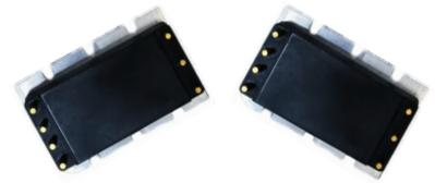
CFMV24C型DC-DC转换器是工业标准1/4砖，输入电压18-40V，最大输出功率150W，内部贴片化设计，国际标准引脚方式，电源采用先进的控制拓扑电路，先进的功率处理控制及封装技术，具有高效率，高功率密度，低噪声等优点；具有输入过欠压保护，输出过流保护，过温保护等功能；产品设计与制造满足SJ20668-1998《微电路模块总规范》和产品详细规范的要求。特别适合航空、航天、船舶、兵器等领域对功率、效率、体积、重量、高度等要求极端严苛的高可靠电子系统。
