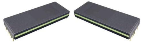
CFJBCM384DC型DC-DC转换器是基于革命性ChiP（Converter housed in Package，转换器级封装）技术的最新一代微晶片电源。采用先进的功率拓扑，控制及封装技术，具有高效率，超高功率密度，超小体积，超轻重量等，可在360V至400VDC的宽输入范围内可靠工作；将控制器、功率管、平面磁性元件以及辅助器件集成在高密度表贴封装内，降低对输入和输出滤波要求，进一步减小总体方案的尺寸和成本；具有输入过欠压保护，输出过压、过流，短路保护以及过温保护、温度监控等功能。产品设计与制造满足SJ20668-1998《微电路模块总规范》和产品详细规范的要求。特别适合航空、航天、船舶、兵器等领域对功率、效率、体积、重量、高度等要求极端严苛的高可靠电子系统。
