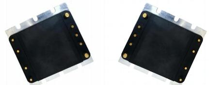
CFMV24B型DC-DC转换器是工业标准1/2砖，输入电压18-40V，最大输出功率250W，内部贴片化设计，国际标准引脚方式，电源采用先进的控制拓扑电路，先进的功率处理控制及封装技术，具有高效率，高功率密度，低噪声等优点；具有输入过欠压保护，输出过流保护，过温保护等功能，产品设计与制造满足SJ20668-1998《微电路模块总规范》和产品详细规范的要求。特别适合航空、航天、船舶、兵器等领域对功率、效率、体积、重量、高度等要求极端严苛的高可靠电子系统。
