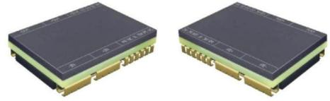
CFJVTM48F型DC-DC转换器是基于革命性ChiP（Converter housed in Package，转换器级封装）技术的最新一代微晶片电源。采用先进的功率拓扑，控制及封装技术，具有高效率，超高功率密度，超小体积，超轻量化等可在26V至55VDC的宽输入范围内可靠工作；将控制器、功率管、平面磁性元件以及辅助器件集成在高密度表贴封装内，降低对输入和输出滤波要求，进一步减小总体方案的尺寸和成本；具有输入过欠压保护，输出过压、过流，短路保护以及过温保护、温度监控等功能。产品设计与制造满足SJ20668-1998《微电路模块总规范》和产品详细规范的要求。特别适合航空、航天、船舶、兵器等领域对功率、效率、体积、重量、高度等要求极端严苛的高可靠电子系统。
