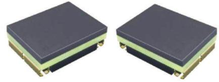
CFJPI28WH12型DC-DC转换器是基于革命性ChiP（ConverterhousedinPackage，转换器级封装）技术的最新一代微晶片电源。采用高性能ZVS拓扑结构，可在9V至50VDC的宽输入范围内可靠工作；将控制器、功率管、平面磁性元件以及辅助器件集成在高密度表贴封装内，具有高达167W/in<sup>3</sup>的超高功率密度，重量仅为7.8g；采用高开关频率，降低对输入和输出滤波要求，进一步减小总体方案的尺寸和成本；具有输入过欠压保护，输出过压、过流，短路保护以及过温保护、温度监控等功能。产品设计与制造满足SJ20668-1998《微电路模块总规范》和产品详细规范的要求。特别适合航空、航天、船舶、兵器等领域对功率、效率、体积、重量、高度等要求极端严苛的高可靠电子系统。
