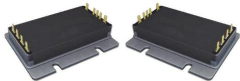
CFJDCM270ATH型DC-DC转换器是基于革命性ChiP（Converter housed in Package，转换器级封装）技术的最新一代微晶片电源。采用先进的功率拓扑，控制及封装技术，具有高效率，超高功率密度，超小体积，超轻重量等，可在160V至420VDC的宽输入范围内可靠工作；将控制器、功率管、平面磁性元件以及辅助器件集成在高密度表贴封装内，降低对输入和输出滤波要求，进一步减小总体方案的尺寸和成本；具有输入过欠压保护，输出过压、过流，短路保护以及过温保护、温度监控等功能。产品设计与制造满足SJ20668-1998《微电路模块总规范》和产品详细规范的要求。特别适合航空、航天、船舶、兵器等领域对功率、效率、体积、重量、高度等要求极端严苛的高可靠电子系统。
