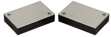
CFMQBS型DC-DC转换器是工业标准1/4砖，本型号电源模块是36V-75V/180V-400V范围输入，最大功率可达到200W，最大效率高达91%的1/4砖系列隔离模块，具有输入欠压、输出过压、输出过流、输出短路及过温保护等保护功能。电源采用先进的控制拓扑电路、先进的功率处理、控制及封装技术，具有高效率、高功率密度、低噪声等优点；产品设计与制造满足SJ20668-1998《微电路模块总规范》和产品详细规范的要求。特别适合航空航天船舶、兵器等领域对功率、效率、体积、重量、高度等要求极端严苛的高可靠电子系统。
