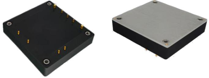
CFAH135S05PJGC为元器件100%普军级全国产半砖AC模块电源,额定输入电压220V<sub>AC</sub>,输出5V<sub>DC</sub>/135W,无最小负载要求,宽电压输入85-264V<sub>AC</sub>,稳压单路输出;高隔离绝缘电压,允许工作温度高达100°C;
